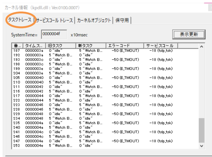
図 2-8 \mu ITRON のタスクトレース情報
